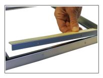
Enlevez les pièces de fixation (profilés) à l'aide d'un tournevis torx de sécurité et retirez les.
